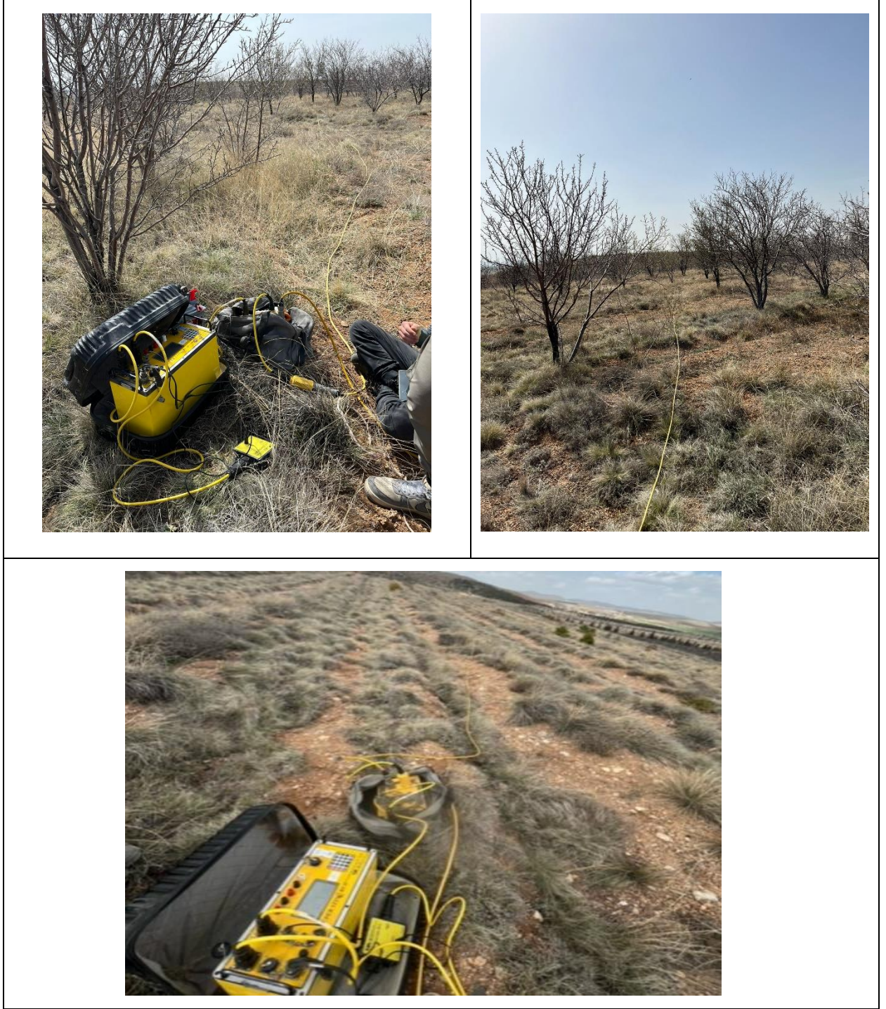
Şekil 7- Konya İli, Selçuklu İlçesi, Ardıçlı Mahallesinde yer alan 1290 parsel üzerinde, yeraltı suyu araştırmasına yönelik olarak jeofizik etüt çalışması. (Bu çalışma arazinin sulama ve kullanma suyu ihtiyacını karşılaması amacıyla yapılmıştır).
