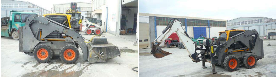
Şekil 14. Çok Amaçlı Uzayabilir Kollara Sahip Yüksek Performanslı Mini Yükleyici
