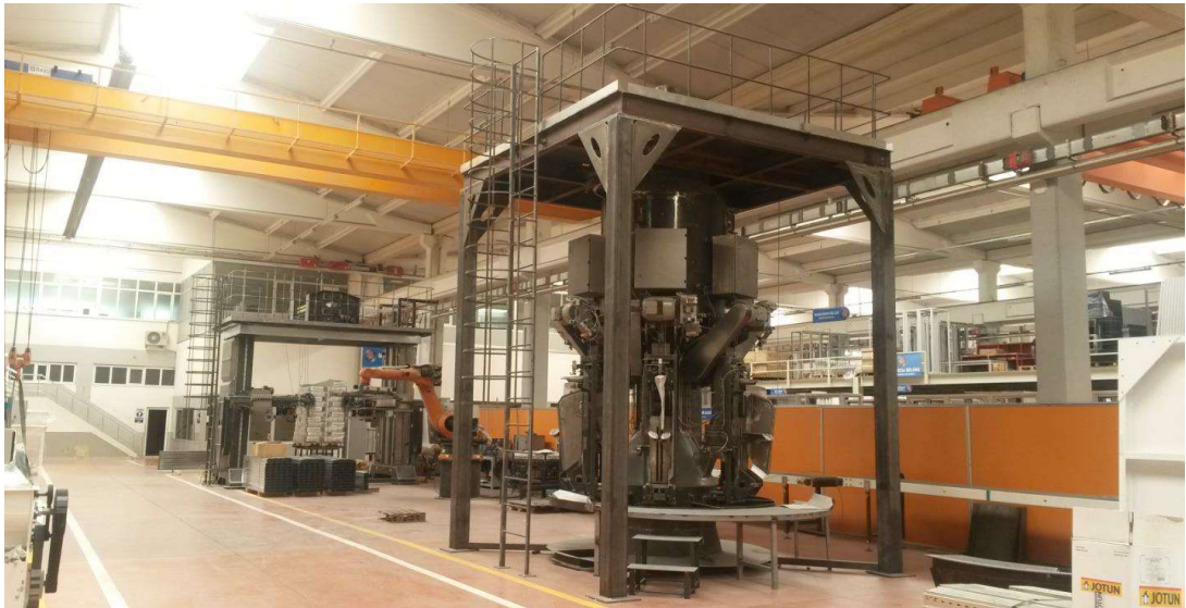
Şekil 21. Tam otomatik un kâğıt paketleme ve sevke hazırlama sistemi
