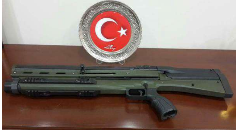
Şekil 11. Sökülebilir şarjörle beslenen gaz geri tepmeli yarı otomatik yivsiz tüfek
