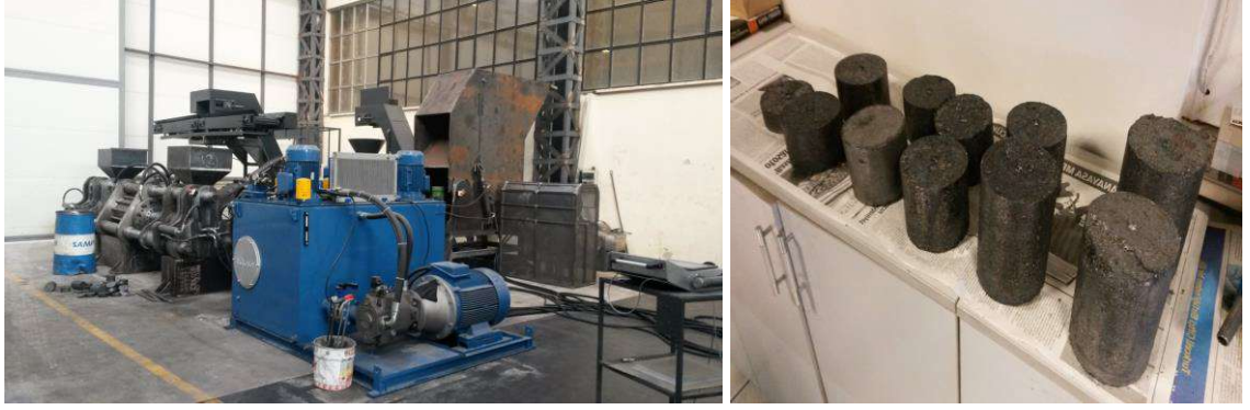
Şekil 15. Tam Otomatik Hurda ve Atık Metal Talaşı Geri Kazanım Sistemi
