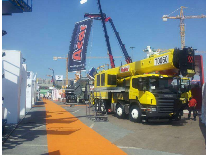
Şekil 17. Yüksek performanslı teleskopik mobil vinç
