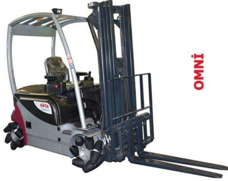
Şekil 13. Çok Yönlü Tekerlere Sahip Yüksek Performanslı Çatallı Yükleyici
