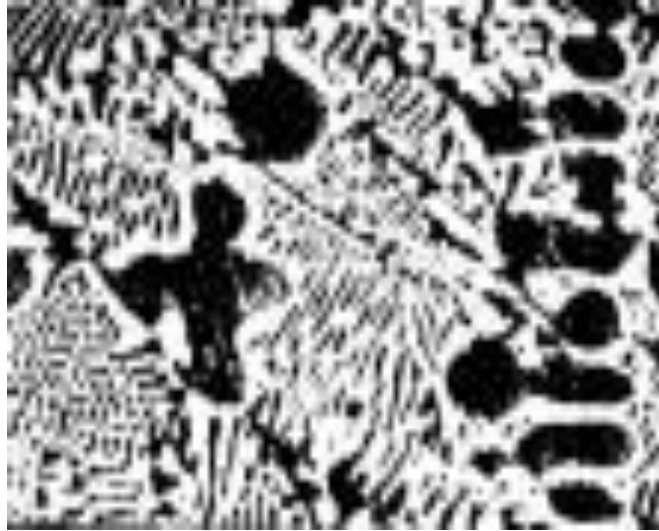
Şekil 8. Ötektik-altı (hipoötektik) beyaz dökme demir (x100). Sementit ve perlitten (siyah) oluşan mikroyapı
