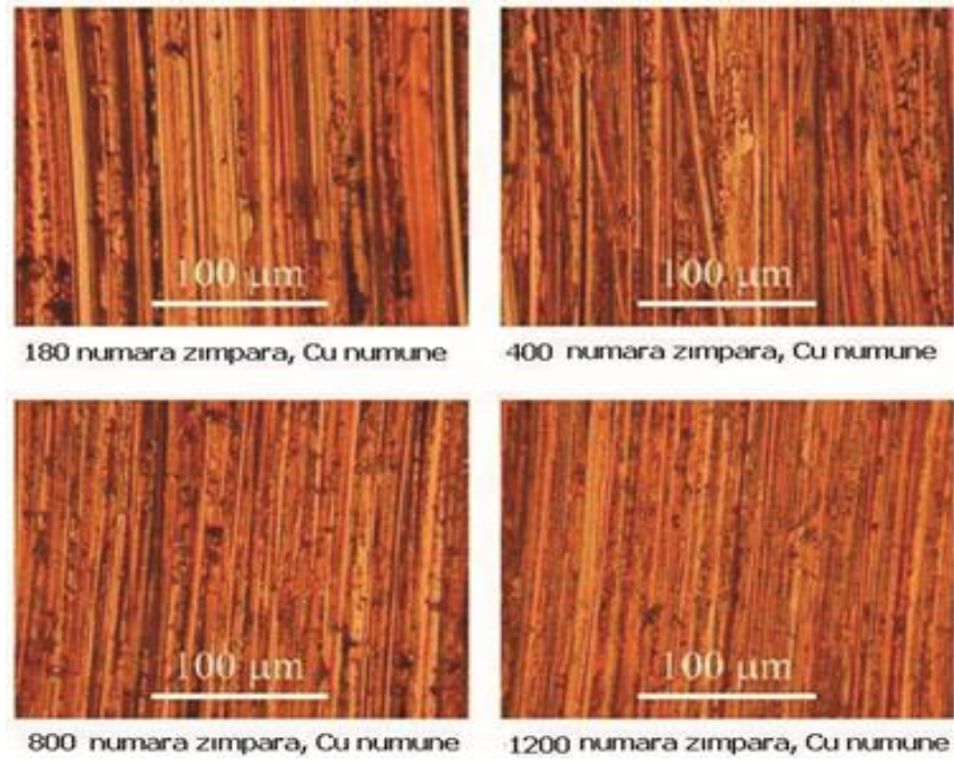
Şekil 9: Cu numune ile başarılı şekilde yürütölmüş zımparalama işlemleri
