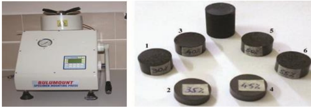
Şekil 4: Bakalite alma cihazı ve bakalite alınmış numuneler
