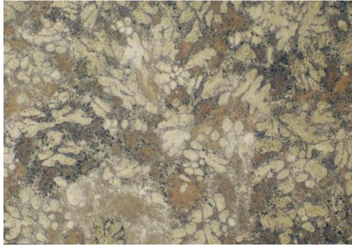
Şekil 25: Zn-Al renkli dağlama yapılmış mikroyapı gösterimi
