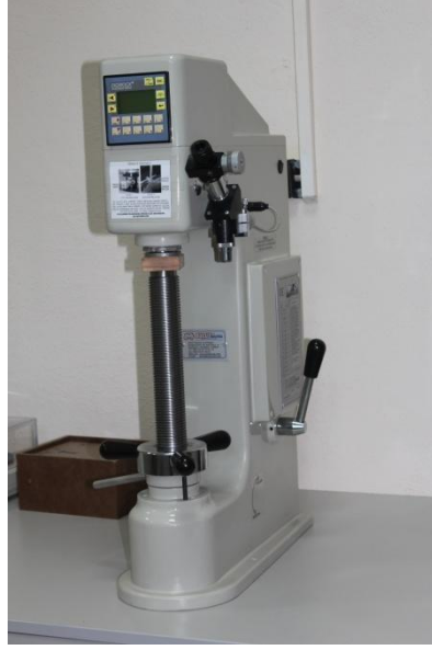
Şekil 1.7 : Sertlik (solda) ve mikrosertlik (sağda) ölçme cihazları (Bulut Makine)
