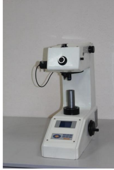
Şekil 1.7 : Sertlik (solda) ve mikrosertlik (sağda) ölçme cihazları (Bulut Makine)
