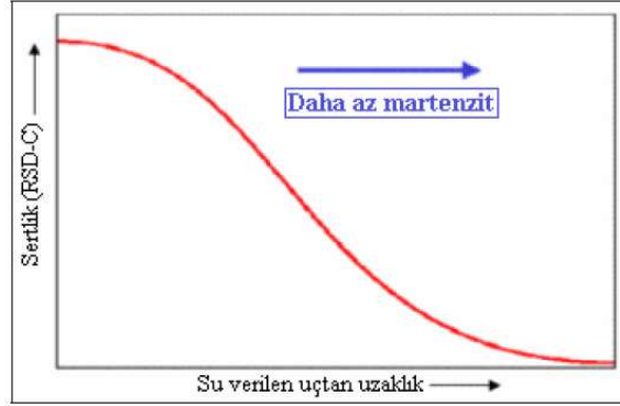
Şekil 5. Jominy deneyi sonucu elde edilen, sertliğin su verilen uçtan uzaklığa göre değişimini veren sertleşebilirlik eğrisi
