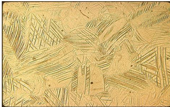
Şekil 15: 200X büyütmedeki fosfor bronzudur.
