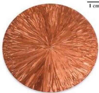
Şekil 1: Merkezden dışarı doğru uzanan iğne şeklinde tanelerin görüldüğü silindirik bir bakır ingot kesiti.
