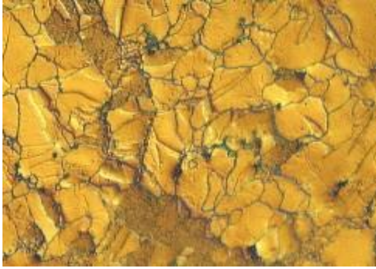
Şekil 26: 100X büyütmedeki saf çinkonun mikroyapısı, dağlayıcısı NaOH ve saf sudur.
