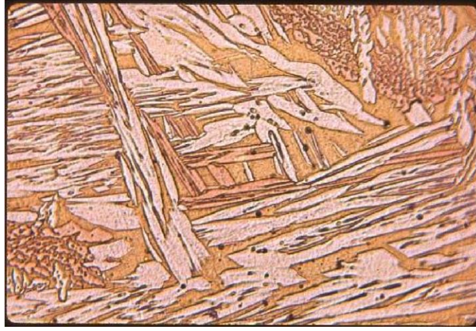
Şekil 13: 200X büyütmedeki Muntz metali (dövülebilir pirinç) yaklaşık %40 Çinko (Zn) içeren bir pirinçtir.
